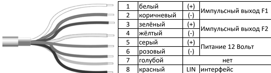
Рис. 3 Схема подключения расходомера с IP68
